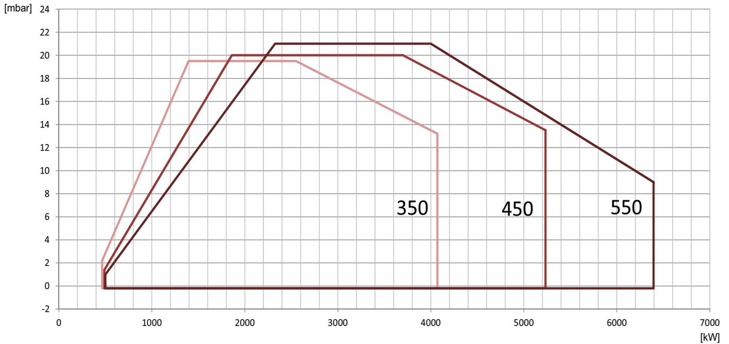
Fig. 2 X = Potenza termica [kW] Y = Pressione in camera di combustione [mbar]
