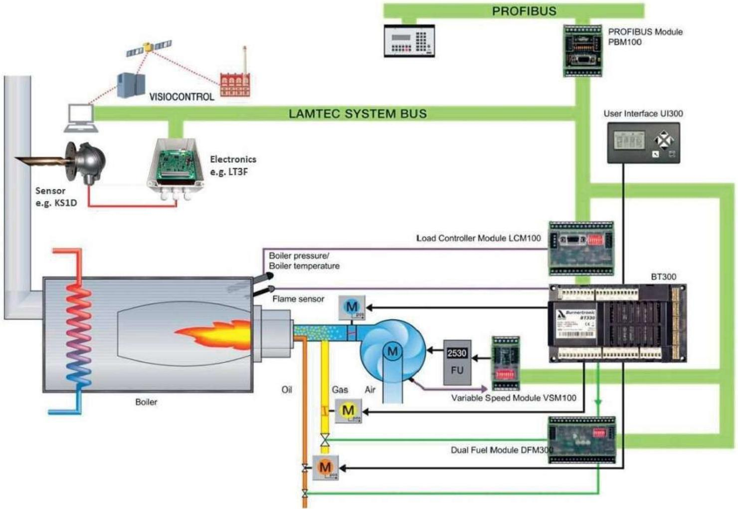
Fig. 1 Camma elettronica Lamtec BT3
