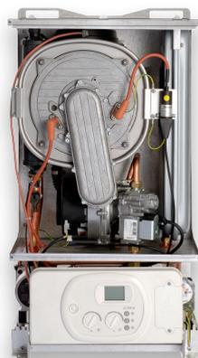
Caldai a condensazione SKY NOVAKOND "R" SOLO RISCALDAMENTO e "RA" Istantanee con mantellatura in ABS resistente agli agenti atmosferici che utilizzano uno scambiatore primario a condensazione a microfiamma radiale e camera di combustione in materiale composito, rinforzata con pareti in acciaio INOX per un totale isolamento termico
