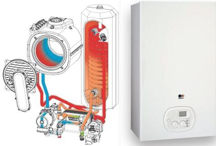
Caldaie a condensazione per circuiti alta/bassa temperatura "RAB 2V" CON ACCUMULO che utilizzano uno scambiatore primario a condensazione a microfiamma radiale e camera di combustione in materiale composito, rinforzata con pareti in acciaio INOX per un totale isolamento termico
