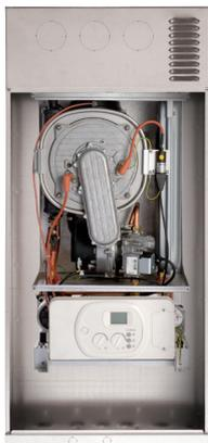
Caldaie a condensazione da incasso NOVAKOND MODULO "R" SOLO RISCALDAMENTO, "RA" Istantanee e "RAB/8" CON MICROACCUMULO da 8 LITRI che utilizzano uno scambiatore primario a condensazione a microfiamma radiale e camera di combustione in materiale composito, rinforzata con pareti in acciaio INOX per un totale isolamento termico
